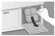
► Retirez le filtre à air **D** en le déplaçant légèrement vers le haut puis en tirant légèrement sur le côté, vers le bas.
